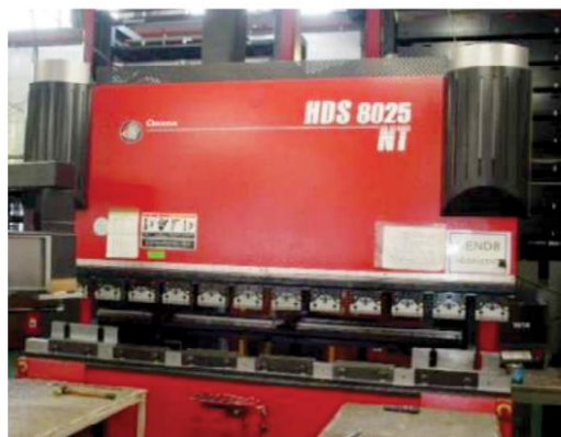
Máy chấn CNC Amada HDS 8025
