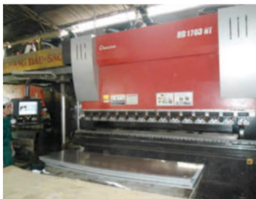
Máy chấn CNC Amada HD 1703 NT
